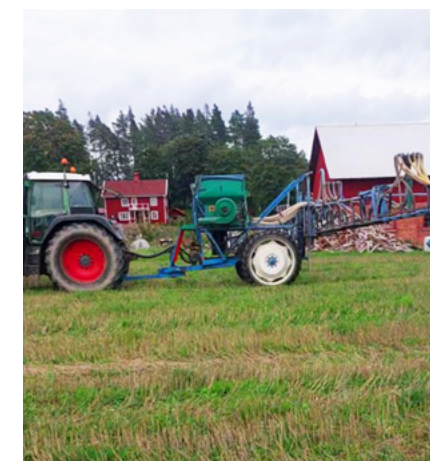
För att kunna så fånggrödan i växande huvudgröda har Fredrik byggt en frösåmaskin på en 24-meters ramp på sin växtskyddsspruta.
